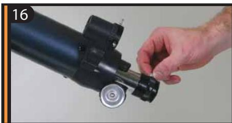
Ослабьте винты-фиксаторы окулярного узла и снимите крышку.
