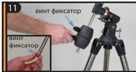
Отвинтите винт-фиксатор с торца штанги противовеса и зафиксируйте их винтом. Закрутите обратно фиксатор штанги противовеса.
