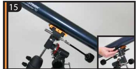
Поместите пластину посередине крепления. Зафиксируйте ее с помощью главного и предохранительного винтов крепления, закрутив их до упора.
