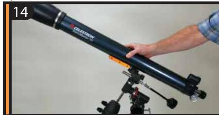
Установите трубу на экваториальную монтировку. Для этого вставьте пластину "ласточкин хвост" в открытую часть паза разреза на монтировке.
