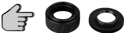
**Примечание:** редуктор-флаттенер поставляется с завода с установленной 6-миллиметровой шайбой. В сборе они могут выглядеть единой деталью. При использовании с ПЗС-камерой эти две детали могут быть разъединены для получения дополнительного расстояния в 6 мм для достижения необходимого заднего фокуса.
