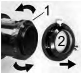
Для установки редуктор-флэттенера на трубку фокусера необходимо снять адаптер 2": придерживайте кольцо (1) одной рукой, а второй – откручивайте адаптер 2" (2).
